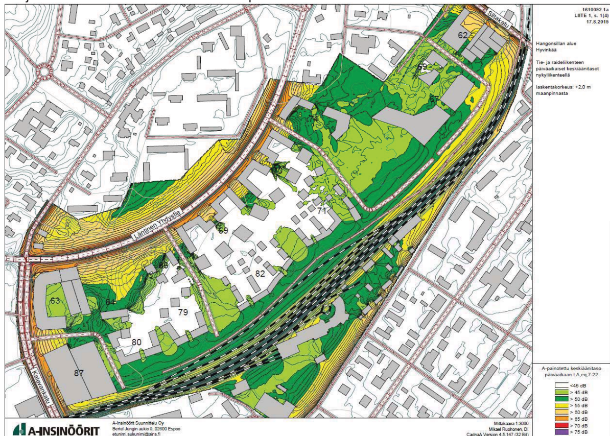
Kuva 11: Ulkoalueiden äänitasot yöaikaan
