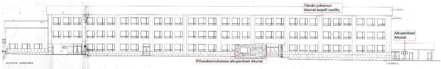
Koulun julkisivukuva lounaaseen. Piharakennuksessa ja kaakkoispäädyn WC-tiloissa on alkuperäiset ikkunat.
