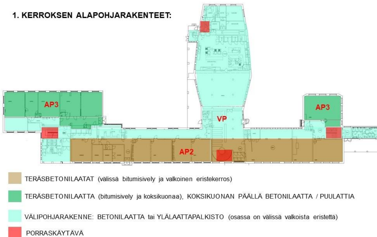
Kuva 3. Rakennuksen 1.kerroksen alapohjarakenteet.
