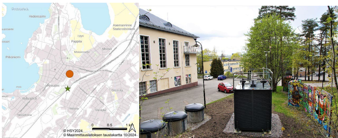
Kuva 9 a–b. Ilmanlaadun mittauspisteet Lohjalla vuonna 2024. a) kartta ja b) valokuva. Jatkuvatoiminen asema on merkitty oranssilla ympyrällä ja typpidioksidin passiivikeräin vihreällä tähdellä.
