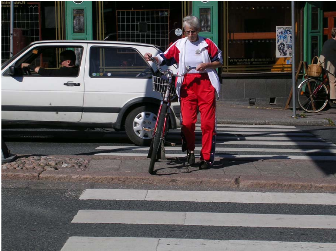
Kuva 15 Uudenmaankadulla on paljon korkeita suojatien reunakiviä. Myös keskisaarekkeet ovat liian kapeita.
